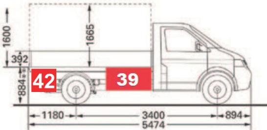
**Radstand 3400 mm** – Einfachkabine, Staubox Mitte rechts
