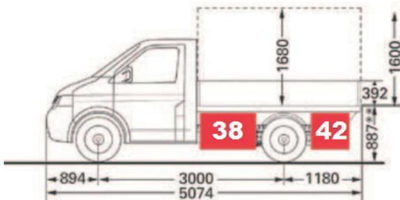
**Radstand 3000 mm** – Einfachkabine, Staubox Mitte links
