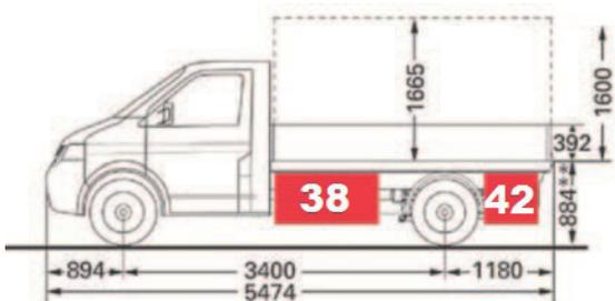
**Radstand 3400 mm** – Einfachkabine, Staubox Mitte links
