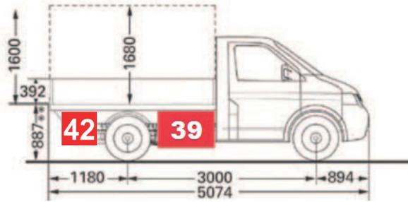
**Radstand 3000 mm** – Einfachkabine, Staubox Mitte rechts
